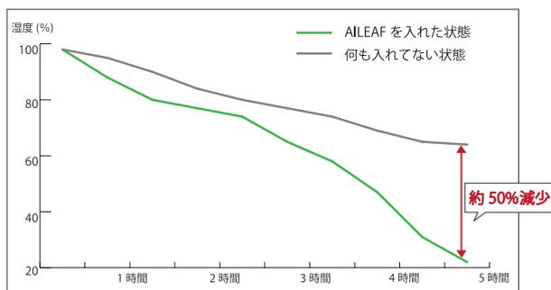
自社実験にて高さ 320 × 横 210mm の円柱型アクリルケースを用意し、ケース内の湿度を 98% にした状態で、AILEAF を入れた状態と入れていない状態で湿度を測る比較実験を行った。
